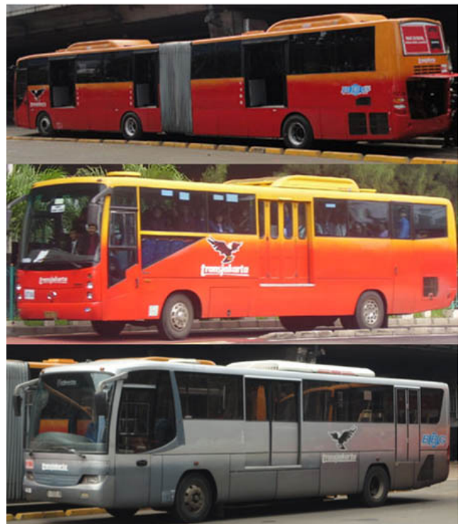
Gambar 2. Armada busway dengan pintu ayun dalam (atas), pintu lipat (tengah) dan pintu geser (bawah).
