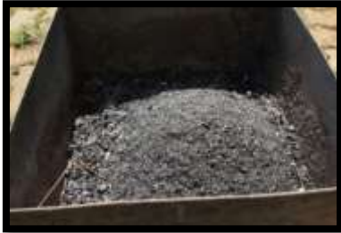
Gambar 3. Sekampadi yang tidak dapat terbakar habis sehingga diperkirakan abu tersebut menyebabkan penyumbatan yang akhirnya zona oksidasi bergeser ke atas dan hasil pembakaran tidak dapat terhisap oleh blower hisap.
