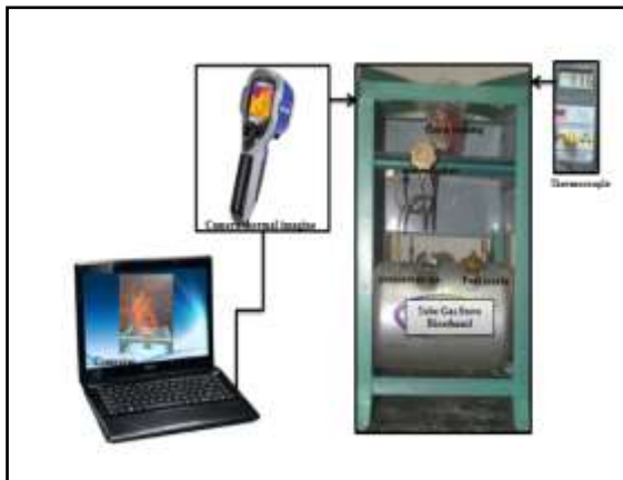
Gambar 2. Eksperimental Penelitian Gas Stove Bioetanol
