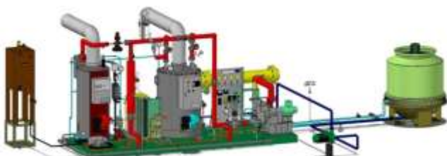
Gambar 1. Modelling Miniatur PLTU Sebagai Alat Uji Coba Penelitian. (Tampak Perspektif)
