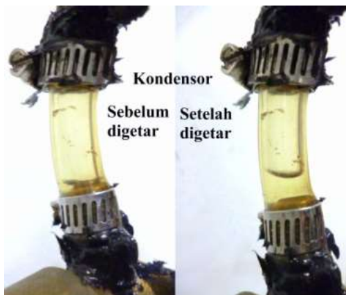
Gambar 18. Pengembunan metanol pada bagian selang transparan di kondensor.
