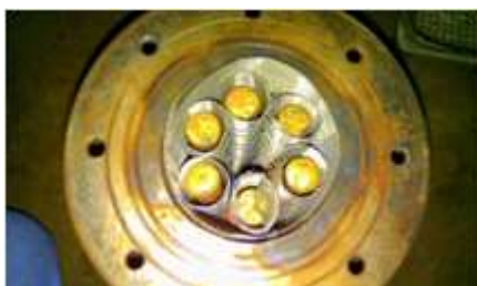
Gambar 14. Posisi kasa dalam tabung adsorber.
