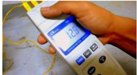
Gambar 19. Efek dingin di evaporator mampu mencapai 12,8°C.
