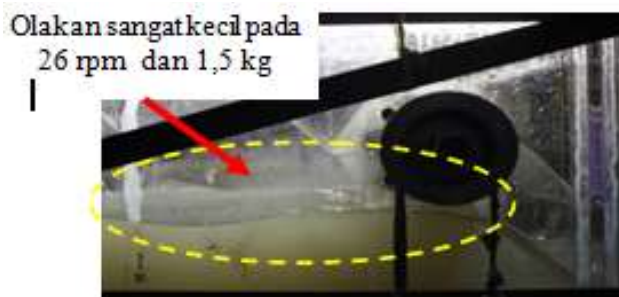
Gambar.10. Foto Kondisi air di sudu 6 plat bengkok untuk efisiensi maks. 54 %
