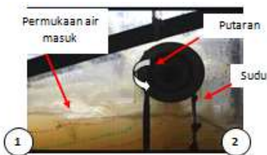
Gbr.2. Foto Perilaku aliran di sudu-sudu untuk 8 sudu pada saluran.
