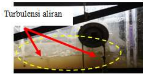
Gambar.11. Foto Kondisi air di sudu 8 plat bengkok untuk efisiensi maks. 39 %
