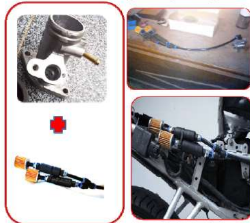
Gambar 3: Modifikasi atau pemasangan air injection
