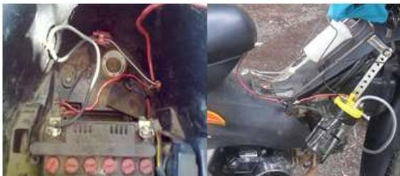
Gambar 4. Pemasangan elektrolizer pada sepeda motor
