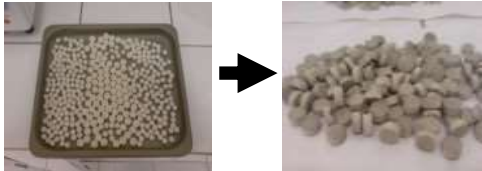
Gambar 1. Zeolit pelet perekat sebelum dan setelah diaktivasi fisik
