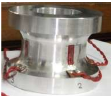
Gambar 4. Pemasangan strain gauge pada loadcell
