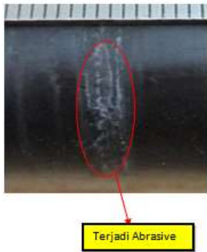
Gambar 5. flyer roll dengan kondisi abrasif pada permukaan rubber cover
