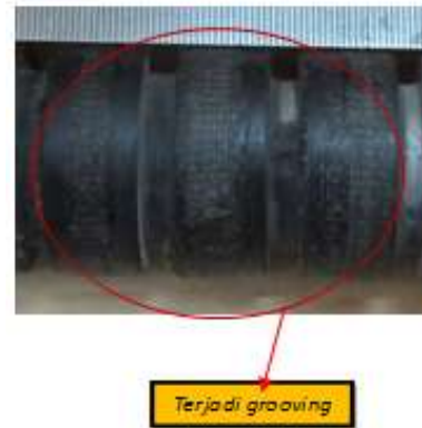
Gambar 4. flyer roll dengan kondisi grooving pada permukaan rubber cover
