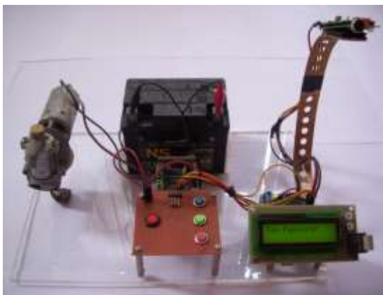
Gambar 6. Prototipe sistem pengenalan suara sebagai pengendali dinamo starter pada otomobil.
