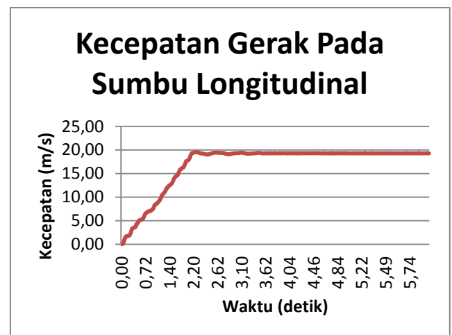
Gambar 12. Kecepatan gerak bogie dengan stabilizing wheel berada sejajar dengan steering wheel pada lintasan lurus dengan kecepatan gerak 70 km/h (19.46 m/s)
