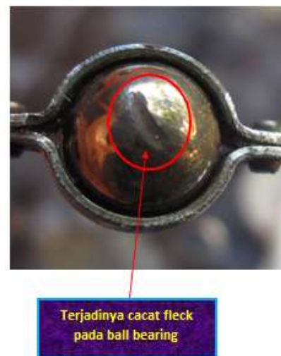
gambar. 2. Ball bearing dengan kondisi cacat akibat adanya korosi.
