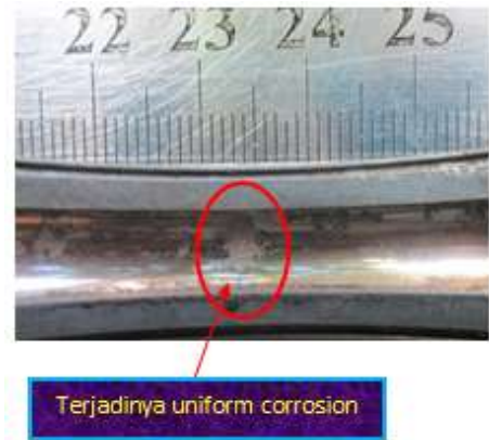
Gambar 1. Outer ring dengan kondisi korosif pada permukaan dalam.
