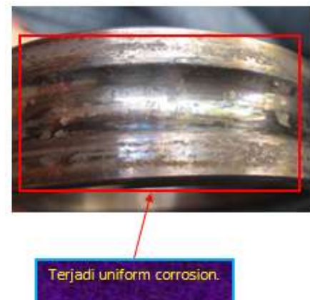
Gambar 3. Terjadi uniform corrosion hampir diseluruh permukaan inner ring
