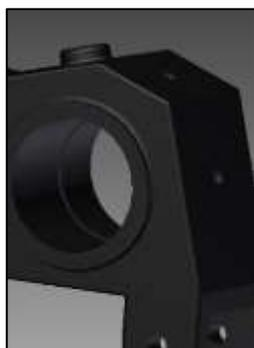
**Gambar 7.** Step penahan *bearing* pada komponen dudukan poros.
