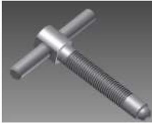
**Gambar 2.** Hasil perancangan ulang poros pemegang.
