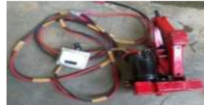
Gambar 9. Dongkrak ulir elektrik, saklar dan kabel
