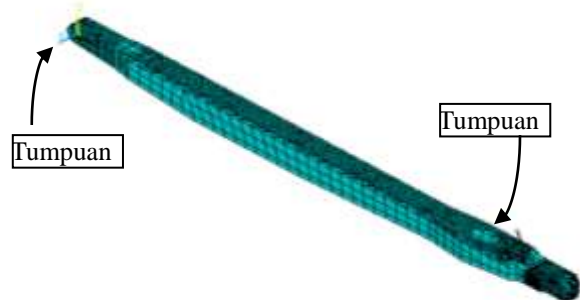
Gambar 7. Model elemen hingga dan posisi tumpuan.
