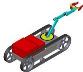
Gambar 4. Model Robot Penjinak Bom dengan gripper
