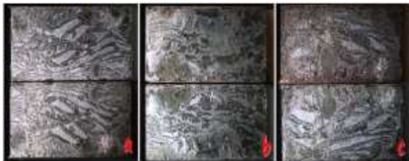
Gambar 5 . Bentuk patahan skala makro pembesaran 2x.
