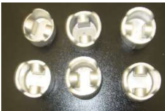
Gambar 1. Piston dibuat secara hot pressing
