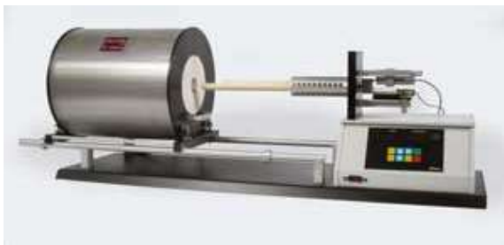
Gambar 4 Alat uji muai panas linear (TDA)
