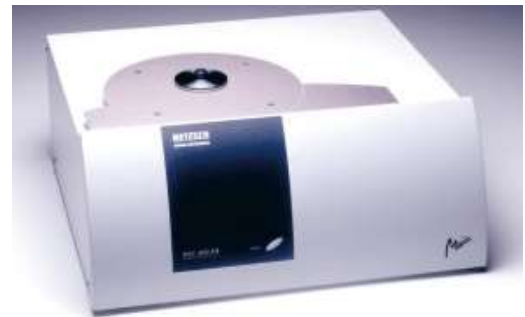
Gambar 2 Alat uji konduktifitas termal
