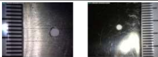
Gambar 7. Overcut pada aluminium (kiri) dan stainless steel (kanan)
