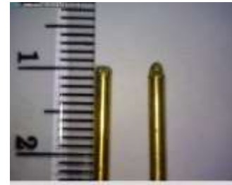
Gambar 6. EW pada aluminium (kiri) dan stainless steel (kanan)
