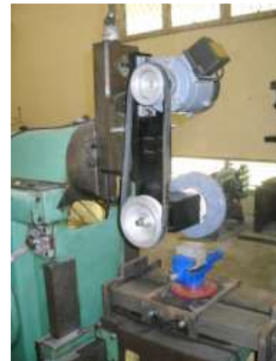
Gambar 5. Alat tambahan yang dipasangkan pada mesin sekrap untuk pemesinan proses freis dan proses gerinda
