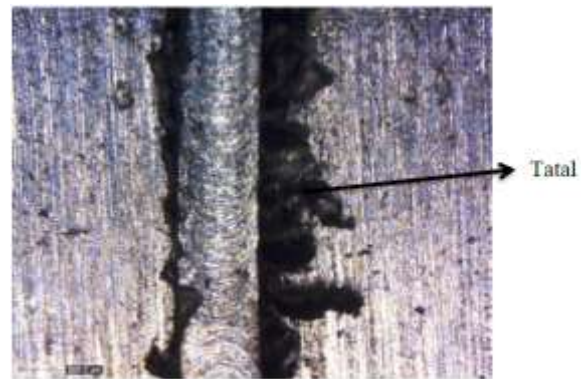
Gambar 3. Hasil permesinan pertama dengan kondisi permesinan: cutting speed 25 m/menit, depth of cut 40 \mu\text{m} , feed rate 1,2 mm/min.
