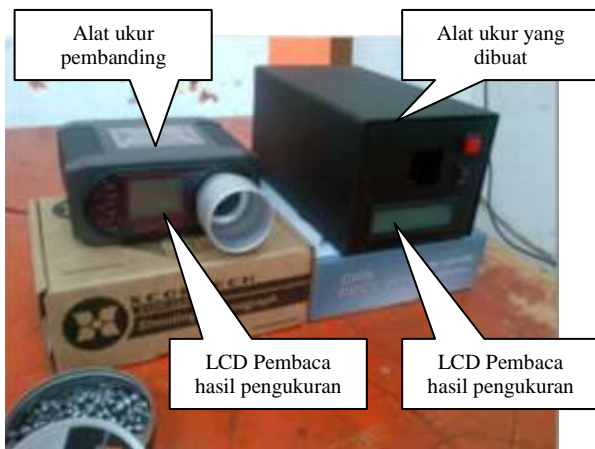
Gambar 7. Bentuk alat ukur yang dibuat dan pembandingnya
