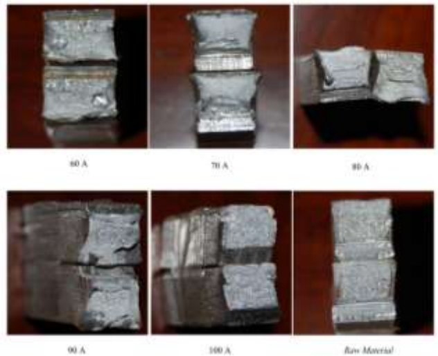
Gambar 3. Patahan spesimen hasil pengujian dampak
