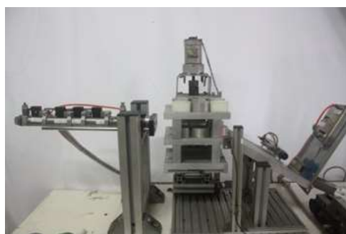
Gambar 11. Rak Modul Lifting bergerak turun sampai Lo6
