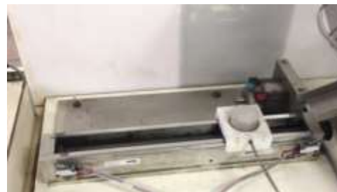
Gambar 13. Benda kerja berada dipallet pada modul transferring
