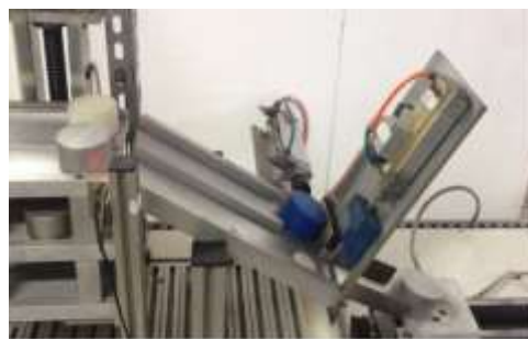
Gambar 12. Silinder jendela terbuka dan benda kerja jatuh menuju holder
