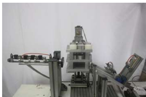
Gambar 10. Silinder pendorong maju ke S2
