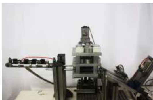
Gambar 10. Silinder pendorong maju ke S2
