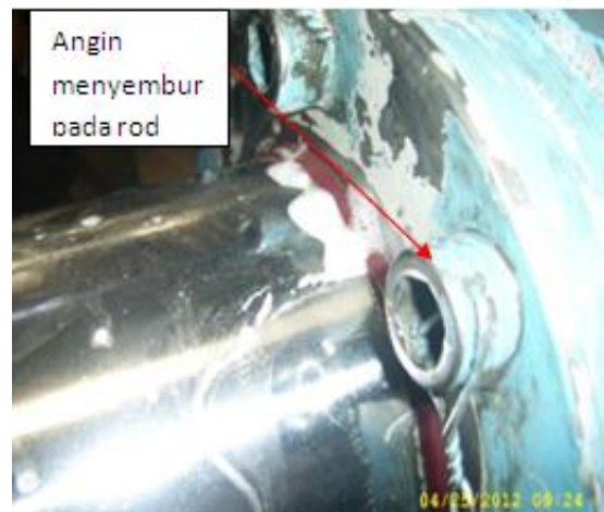
Gambar 4. Terjadi Kebocoran Antara Rod dan Gland
