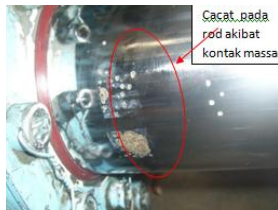
Gambar 5. Cacat Pada Rod Akibat Kontak Arus listrik Welding
