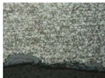
Gambar 8. Struktur mikro sampel pipa furnace di bagian permukaan dalam ( inside area ) perbesaran 100X (diambil pada Jumat, 4 Desember 2013).
