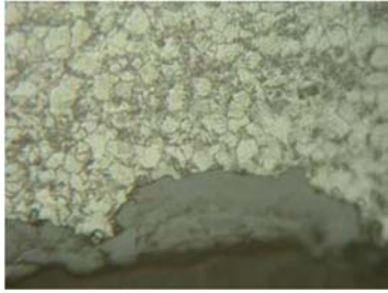
Gambar 9. Struktur mikro sampel pipa furnace di bagian permukaan dalam ( outside area ) perbesaran 200X (diambil pada Jumat, 4 Desember 2013)
