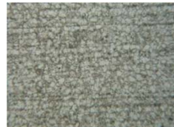
Gambar 6. Struktur mikro sampel pipa furnace di bagian permukaan tengah ( core area ) perbesaran 100X (diambil pada Jumat, 4 Desember 2013).
