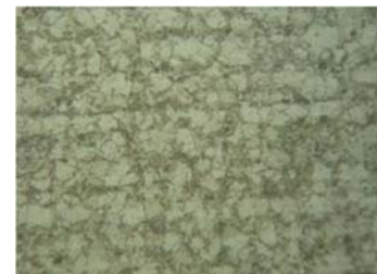
Gambar 7. Struktur mikro sampel pipa furnace di bagian permukaan tengah ( core area ) perbesaran 200X (diambil pada Jumat, 4 Desember 2013).
