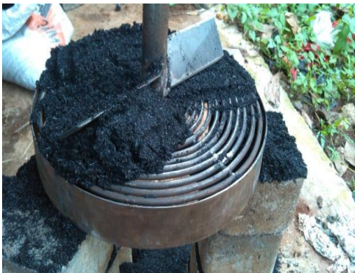
Gambar 2 Proses Pengadukan pada Grate
