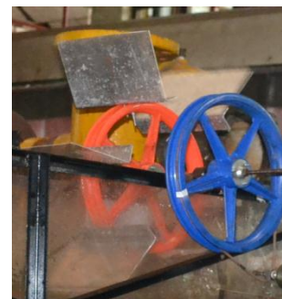
Gambar 4. Foto 6 sudu plat pada saluran air
