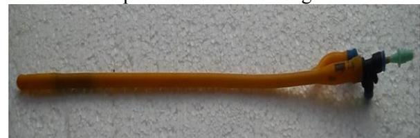
**Gambar. 6** Kateter setelah dipasangkan dengan perangkat selang dan pipa tembaga.
