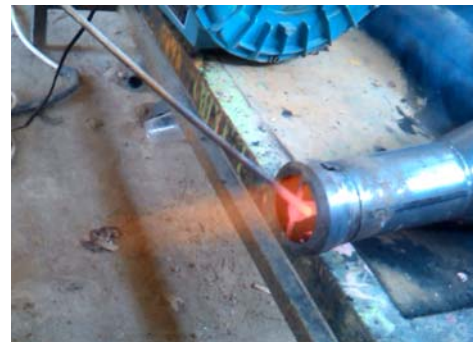
Gambar 6 nyala api pada kondisi jet flame
