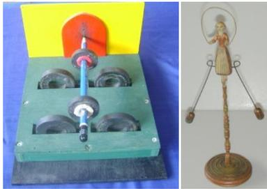
Gambar 2. Pelayangan pensil untuk menggambarkan konsep *magnetic levitation* dan penjelasan prinsip kesetimbangan menggunakan bandul berputar
