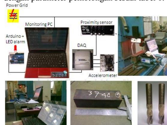
**Gambar 1. Setup percobaan, benda kerja dan pahat yang digunakan dalam penelitian**
