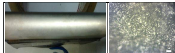
Gambar 2. Foto makrostruktur uji adhesivitas lapisan krom
