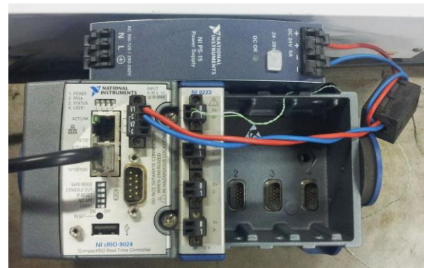
Gambar 2. Modul RealTime dan FPGA
