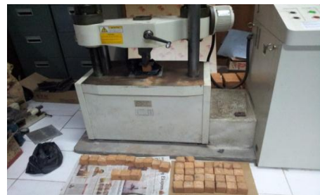
Gambar 2.5. Proses pengujian kuat tekan dengan menggunakan universal Testing machine
