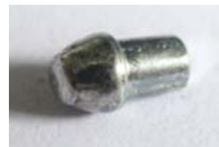
Gambar 7. Peluru yang Telah Mengalami Deformasi Plastis
