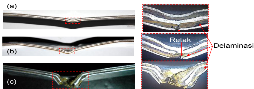
Gambar 5. Potongan melintang spesimen Al/Bb-3/2 (anyam) setelah uji impact pada energi impact (a) 25 J, (b) 37,5 J, dan (c) 50 J.
