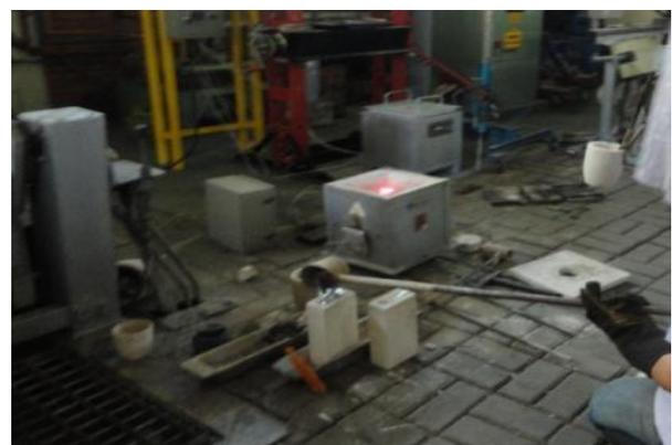
**Gambar 5.** Penuangan aluminium cair ke dalam cetakan
