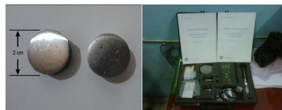
Gambar 3. Spesimen uji keras dan *mobile hardness tester*
