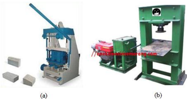
Gambar 1(a). Alat pemadat manual, (b). Alat pemadat hidrolik [2]
