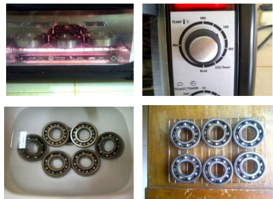
Gambar 2. Proses penuaan ( aging ) pada bantalan
