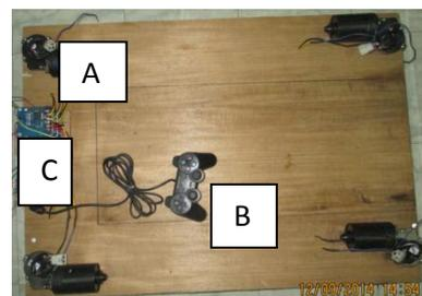
Gambar 12. 4 Motor (A) untuk belok, sebuah remote (B) dan sebuah mikrokontroler (C).
