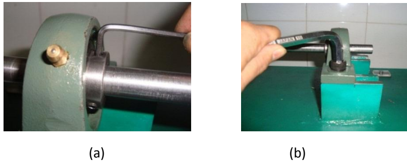
Gambar 10 Posisi loosness (a) bantalan-poros (b) rumah bantalan
