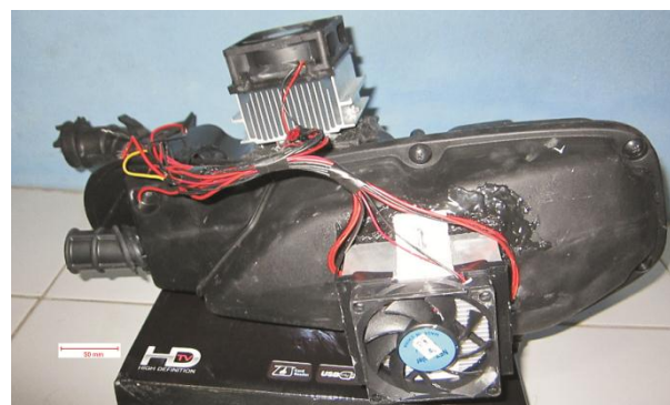
Gambar 8. Pendingin udara pada air duct
