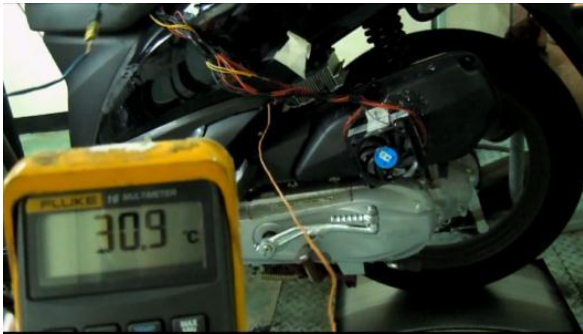
Gambar 10. Pengukuran temperatur pada air duct .
