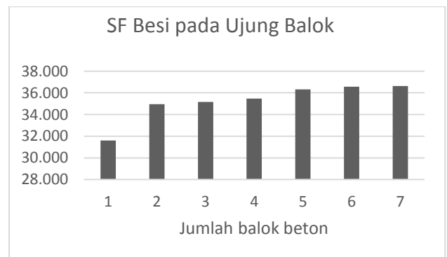
Gambar 6. Grafik SF besi tulangan pada bagian ujung balok beton
