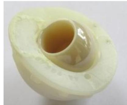
Gambar 2. AHJ yang dibahas dalam penelitian ini, memperlihatkan acetabular liner dari bahan UHMWPE dan femoral head dengan bahan keramik
