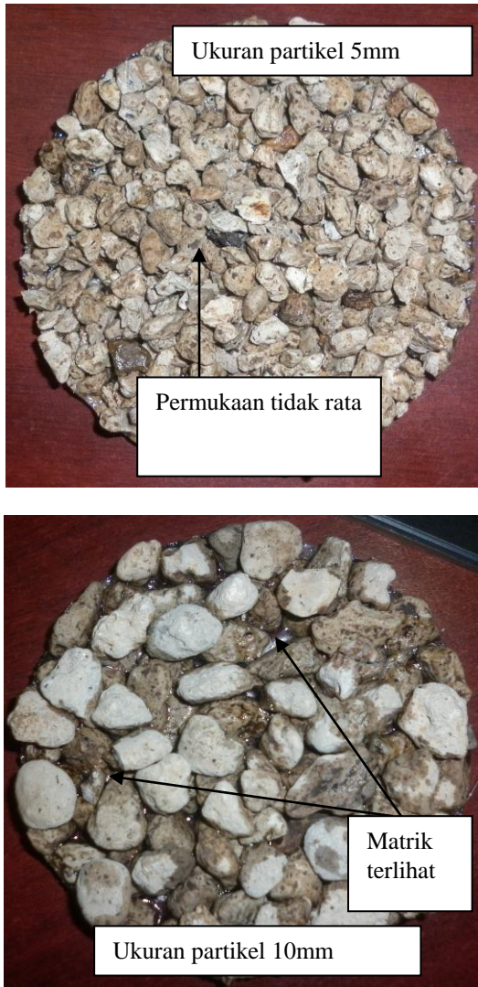
Gambar 4. Spesimen penyerapan suara dengan fraksi berat 60%
