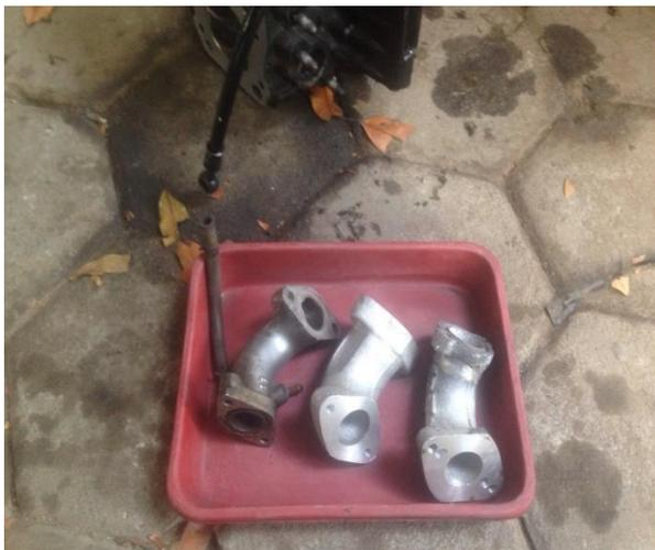
Gambar 3. *Intake Manifold Modifikasi*
