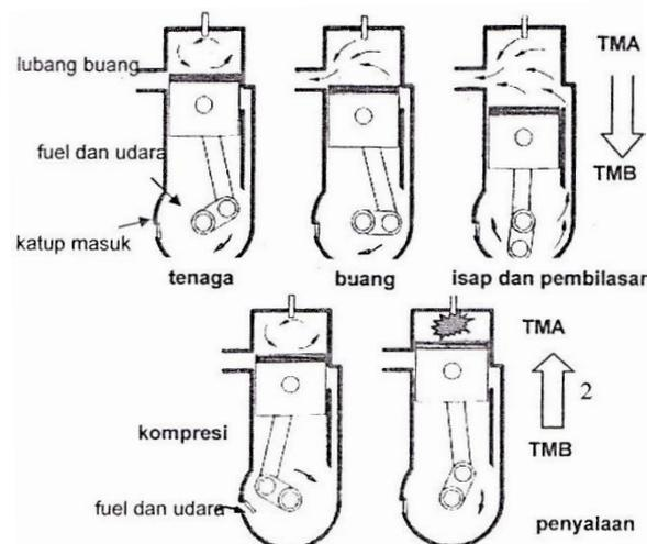
Gambar 2. Proses Kerja 2 Langkah
