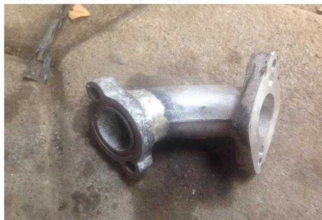
Gambar 6. Intake Manifold Modifikasi 1
